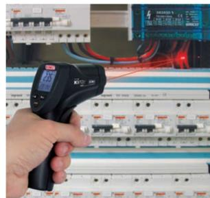
La visée laser permet de cibler précisément un objet.
