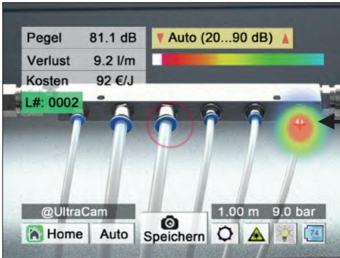
La UltraCam LD 500/510 utiliza 30 micrófonos MEMS para calcular y visualizar la imagen ecográfica. Además, el dispositivo permite oír ultrasonidos inaudibles
