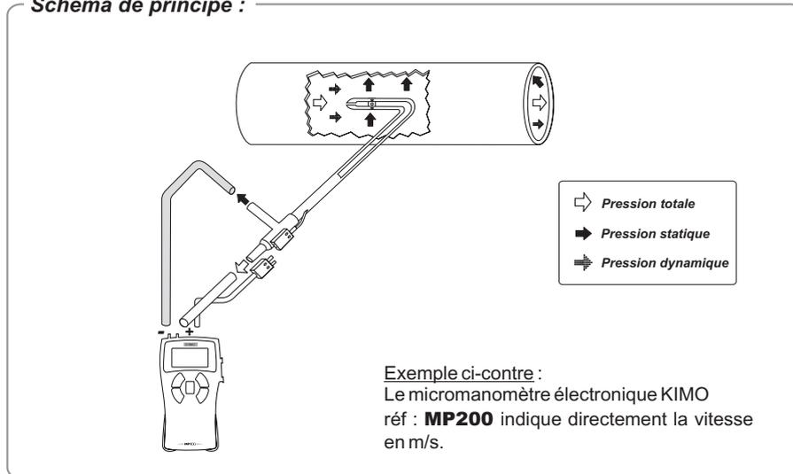
A partir de la pression dynamique exprimée en mm CE ou en Pa, on détermine la vitesse en m/s par la formule simplifiée de BERNOULLI.
